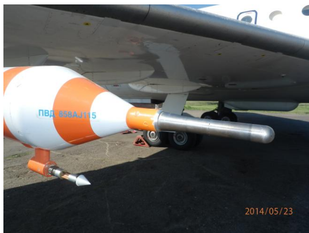
Рисунок 2.4 — Общий вид подкрыльевой штанги и размещение на ней датчиков температуры ВДТ, Rosemount 102CT2CB и 102LA2AG, преобразователя давлений Rosemount MADT2016, блока интерфейсов датчиков БИД-1 и приемника давления 858AJ на подкрыльевой штанге
