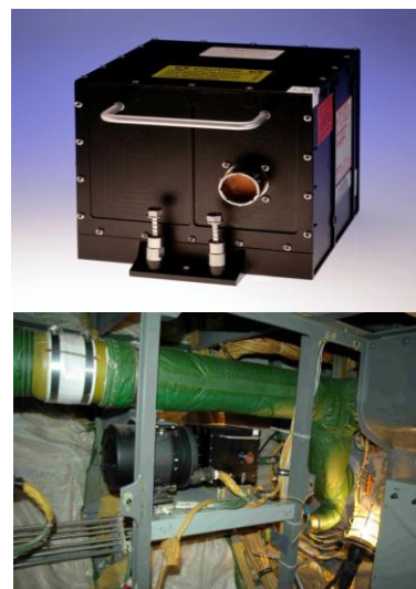
Рисунок 2.3 — Инерциальная навигационная система Laseref VI и её размещение на самолёте-лаборатории Як-42Д «Росгидромет»
