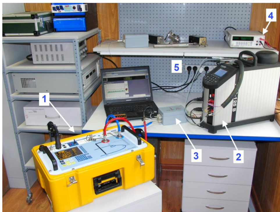
Рисунок 3.3 — Внешний вид лабораторного стенда для исследований датчиков давления и температуры (1 — тестер воздушных сигналов ADTS505; 2 — калибратор температуры АТС125В; 3 — блок интерфейсов датчиков БИД; 4 — блок питания НУ3050Е; 5 — регистрирующий компьютер).
