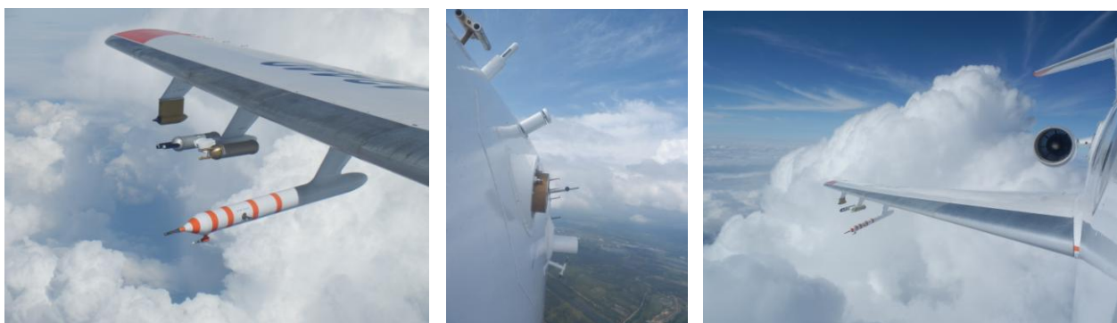
Рисунок 2.10 — Вид датчиков АПК-1 (на подкрыльевой штанге и на боковой поверхности фюзеляжа) во время проведения исследований
