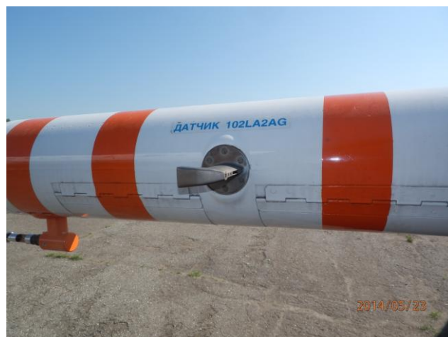
Рисунок 2.4 — Общий вид подкрыльевой штанги и размещение на ней датчиков температуры ВДТ, Rosemount 102CT2CB и 102LA2AG, преобразователя давлений Rosemount MADT2016, блока интерфейсов датчиков БИД-1 и приемника давления 858AJ на подкрыльевой штанге
