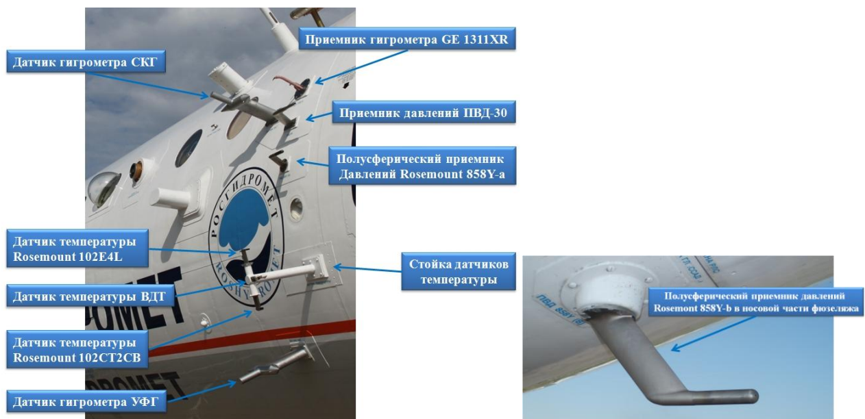
Рисунок 2.6 — Расположение датчиков дублирующего термодинамического комплекса АПК-1 на фюзеляже самолёта-лаборатории Як-42Д «Росгидромет»
