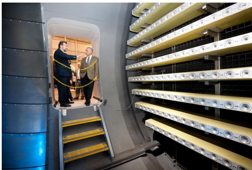
Рисунок 1.5 — Аэродинамическая труба с системой создания водности в исследовательском центре Glenn NASA
