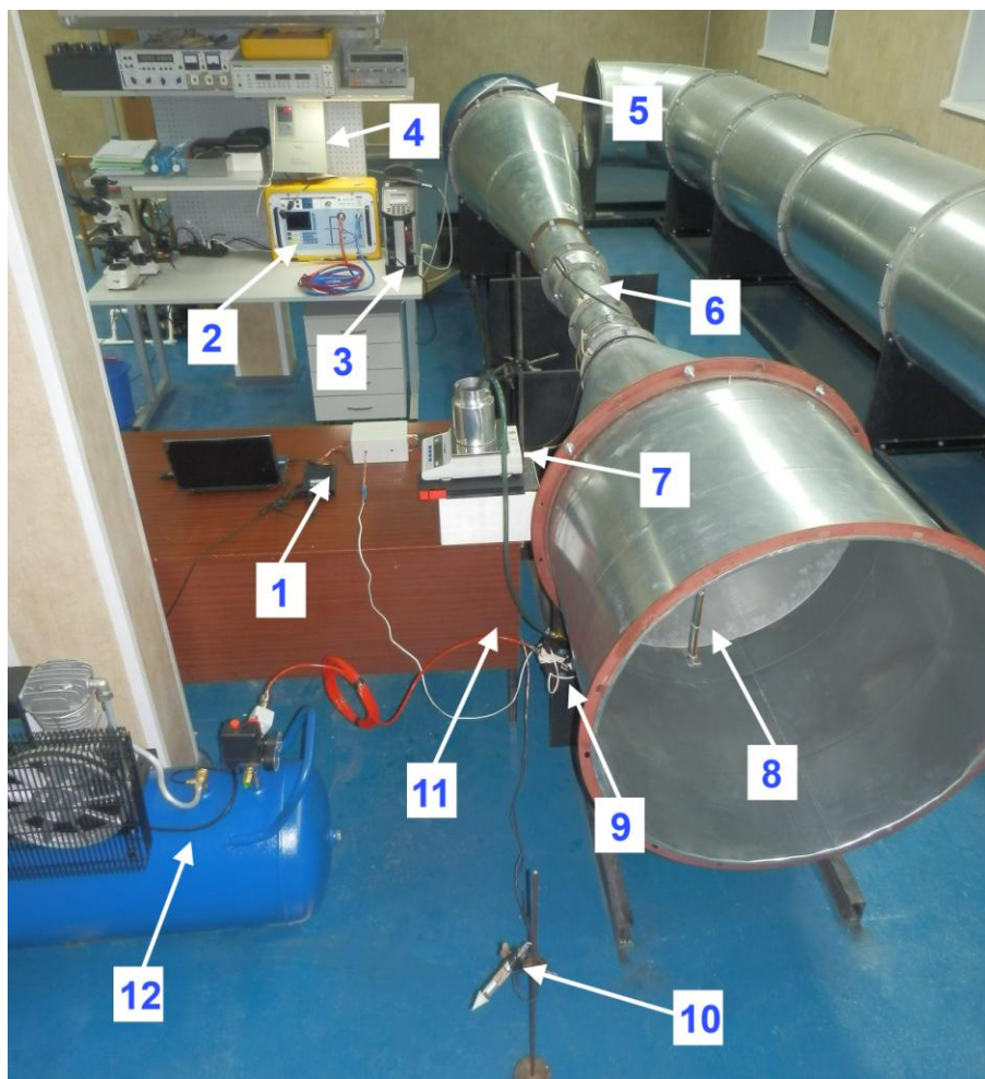
Рисунок 3.8 — Специальная аэродинамическая установка САУ (1 — компьютер, блок содержащий мостовую прецизионную плату и плату для оцифровки данных, 2 — калибратор температуры АТС-125В, 3 — калибратор давления ADTS505, 4 — регулятор оборотов вентилятора, 5 — вентилятор, 6 — рабочая камера с датчиками и приемником давления 7 — весы с емкостью для воды, 8 — державка пневматической водяной форсунки, 9 — запирающие клапана форсунки, 10 — датчик температуры ВДТ в комнате, на входе в трубу, 11 — магистрали подачи воды и воздуха 12 — воздушный компрессор для пневматической форсунки)
